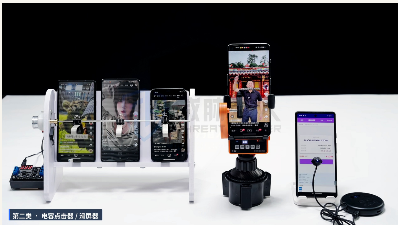
FIG. 2 第二类设备：电容点击器与滑屏器。电容触头或机械结构真实作用于屏幕，重复完成点击和滑动。
