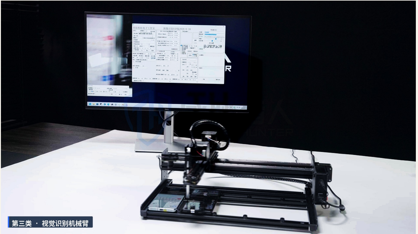
FIG. 3 第三类设备：具备视觉识别的机械臂。摄像头读取页面后，再由机械结构完成真实点击和滑动。
